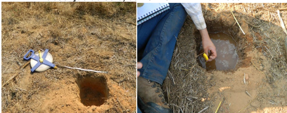
Figura 35. Apresentação de ensaio de permeabilidade/capacidade de absorção do solo, conforme NBR-7.229/1993.
